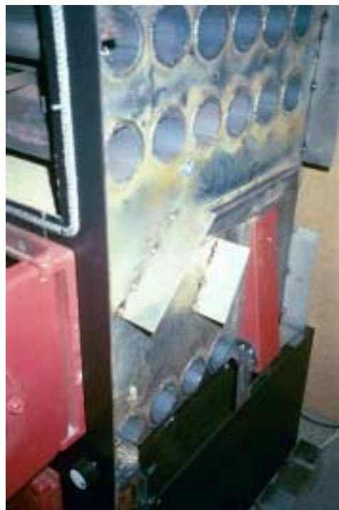
Bilden visar pannan från sidan och visar samtidigt hur en separat sekundärluftkanal leds upp och tillförs överkanten av eldstaden.
