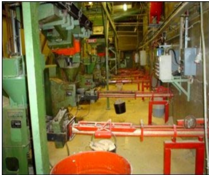
Brikettpressarna i Norberg har en kapacitet på 5 ton per timma
